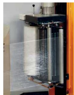
Solution avec Power-Pre-Stretch: Préétirage du film jusqu'à 300% (option) – utilisation optimale du film!
