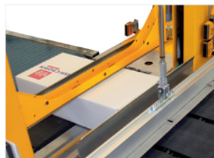
Paket-/Bündelanschlag Zum Ausrichten von losen Bündeln oder Paketen
