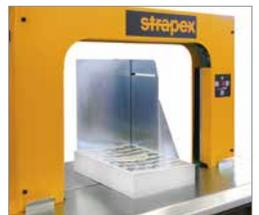
**Paketanschlag** zum Ausrichten von losen Bündeln
